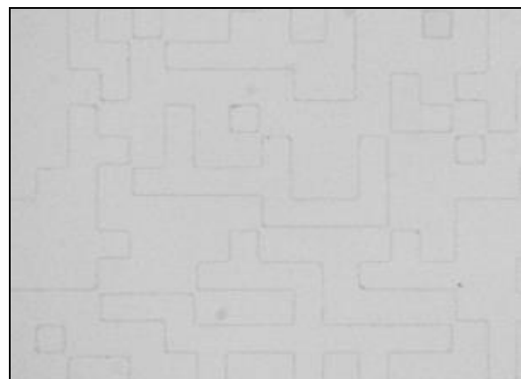
3. ábra. Fázistárgy leképzése térben inkohereus fényvel. A fázislépcsők határán fellépő destruktív interferencia láthatósága jelentősen romlott.
